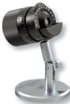
Эта модель глаза идеально подходит для обучения и практики. Точная установка диаметра зрачка и ошибки рефракции и, следовательно, возможность их воспроизведение. В передний держатель отсека для линз можно установить до двух пробных линз. Градуированная шкала для определения цилиндров.
